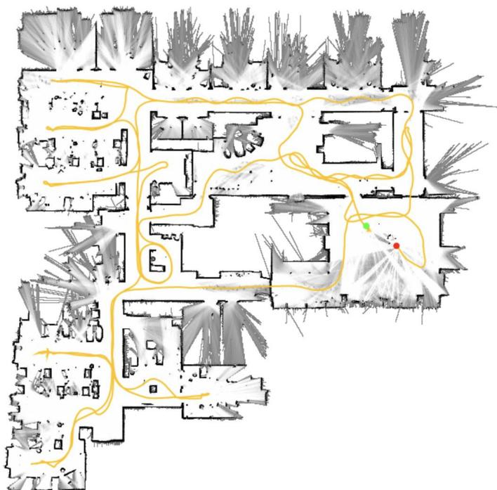
图 1: 基于 Synexens ToF 芯片 R5001 的旋转激光雷达 SLAM 建图
