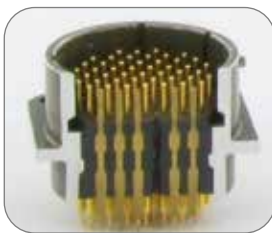
PCB receptacle cross section Coupe d'embase PCB
